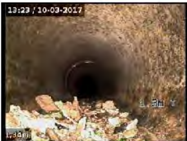
Dépôts et fissure à l'intérieur des canalisations existantes
